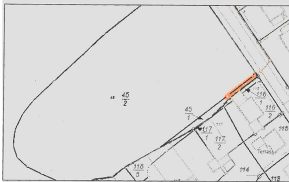
Abb. 4: Anlagen der Schmutzwasserableitung mit Schutzstreifen von 4,0 m auf FS 45/1 (Gem. Neuendorf, Flur 7)
