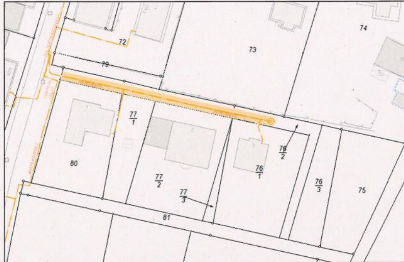
Abb. 2: Anlagen der Gasversorgung mit Kennzeichnung Schutzstreifen
