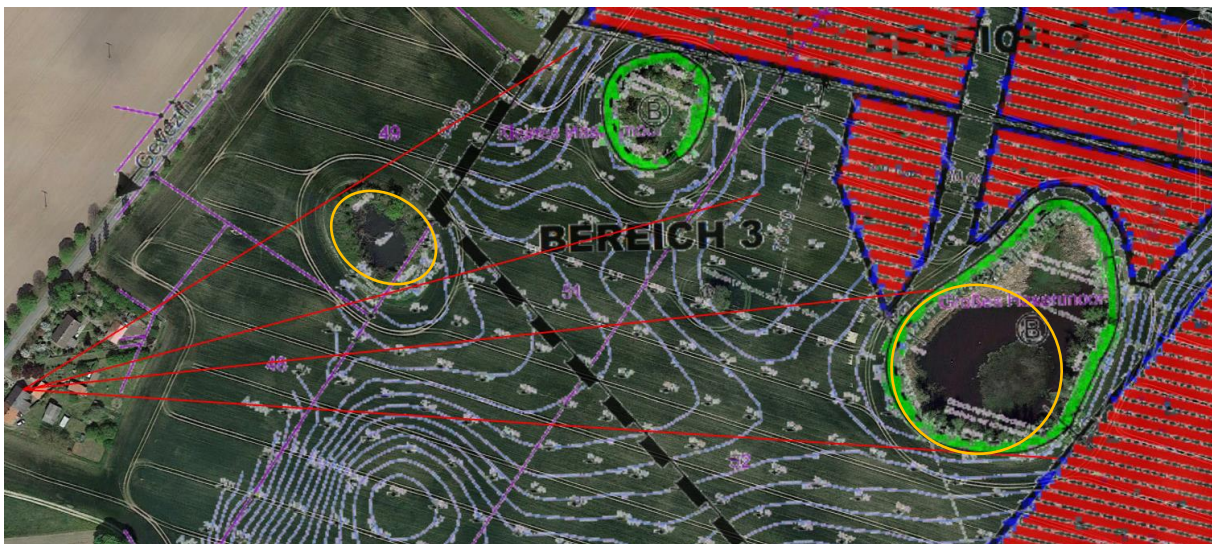
Abbildung 6: Filterung durch Sichtunterbrechung (orange) zwischen 58,3^\circ - 75,0^\circ und 83,8^\circ - 93,8^\circ (als rote Linien) für OP 4
