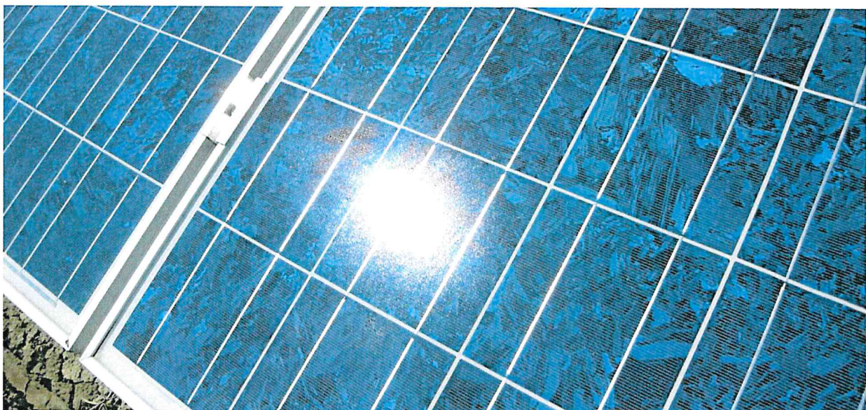
Bild 3.2.2: Diffuse Reflexion von direktem Sonnenlicht (Einstrahlung ca. 980 W/m 2 ) auf einem PV Modul (Quelle: SolPEG)
